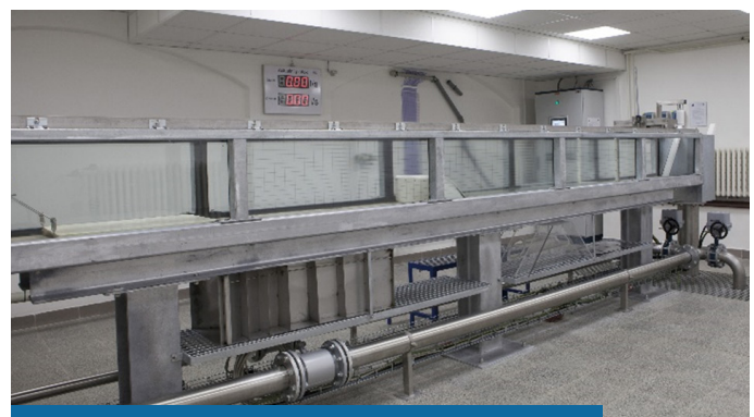
Versuchsrinne des Wasserkreislaufs, Breite 0,36 m, Länge 6,5 m, Wassertiefe 0,4 m, Durchflusskapazität 36 l/s / Baufachschule Vysoké Mýto, CZ
