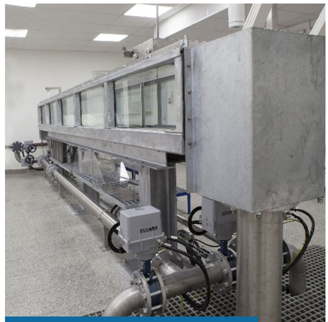
Hydraulischer Kreislauf des Wasserbaulabors Durchflusskapazität 36 l/s / Baufachschule Vysoké Mýto, CZ
