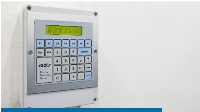
Bedieneinheit für eine schnelle und einfache Parametereinstellung des Kreislaufs / TU Brno, CZ
