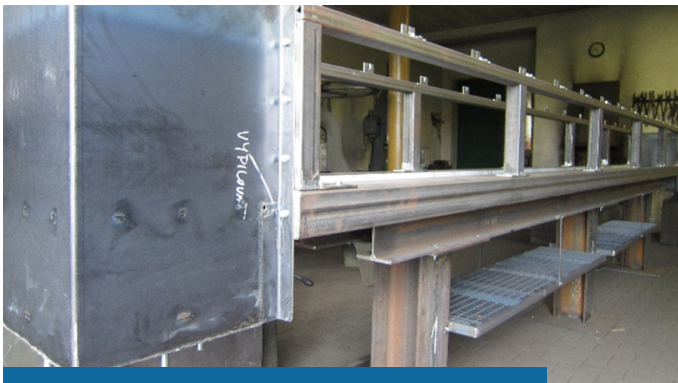
Versuchsrinne nach der Herstellung und vor der Verzinkung
