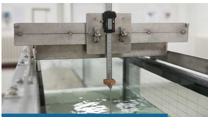
Digitaler Stechpegel auf dem Instrumententräger der Rinne / Baufachschule Vysoké Mýto, CZ
